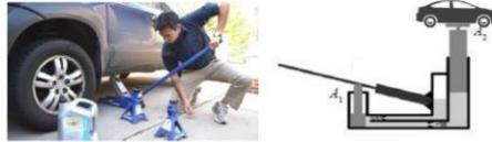
Gambar A. Ayah sedang mendongkrak mobil Gambar B. Ilustrasi dongkrak mobil
